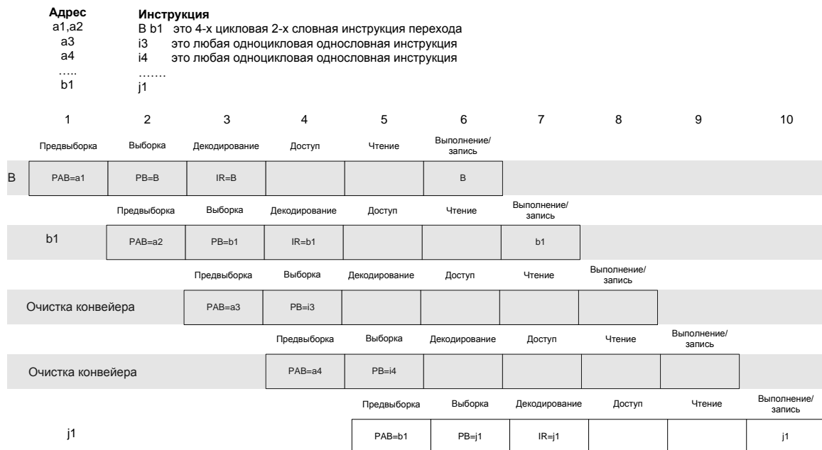
Рисунок 17–13 – Инструкция перехода в конвейере
