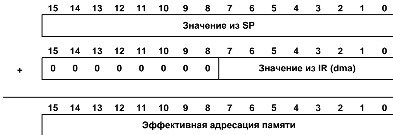
Рисунок 17–35 – Прямая адресация, связанная с SP
