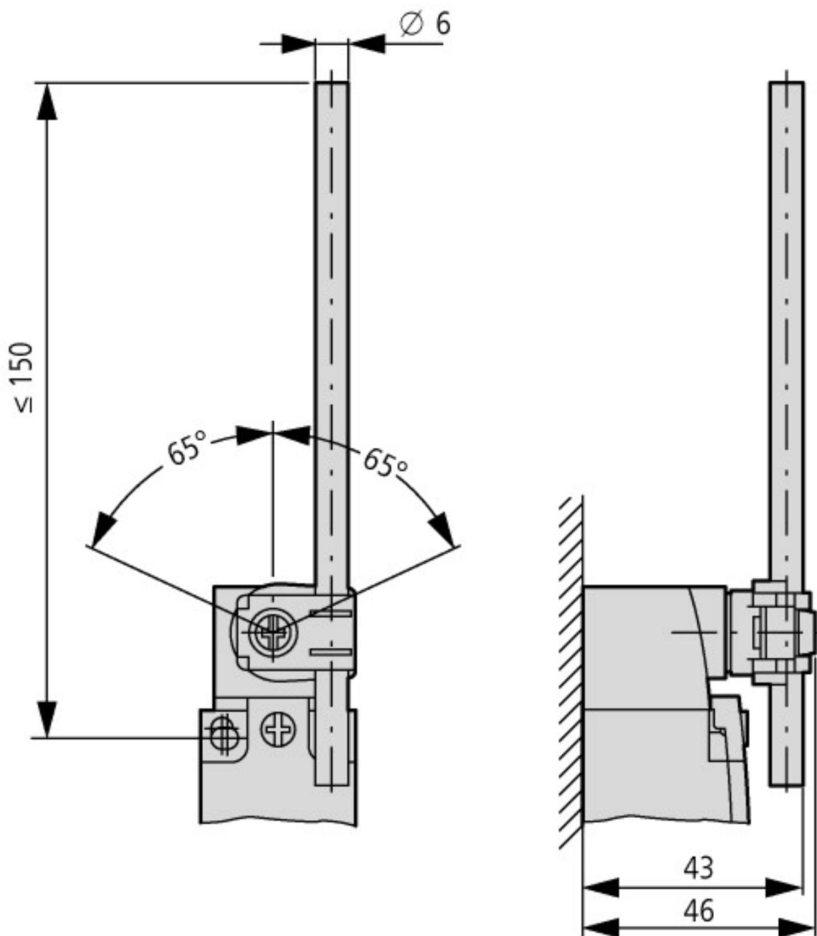
① Вращающий момент затяжки винта крышки: 0,8 Нм  $\pm 0,2$  Нм
