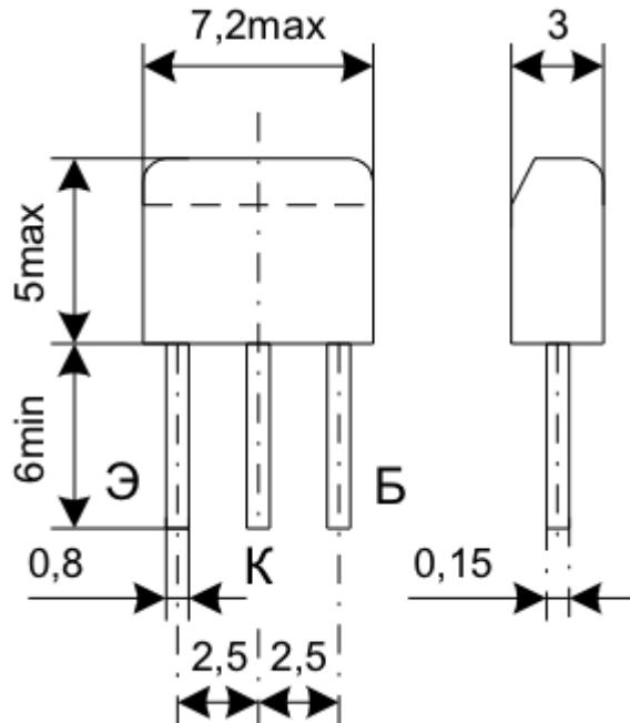
Тип прибора указывается на корпусе полностью, либо в виде буквы соответствующего типономинала в левом верхнем углу лицевой части корпуса прибора напротив вывода эмиттера. Масса транзистора не более 0,18 г.
