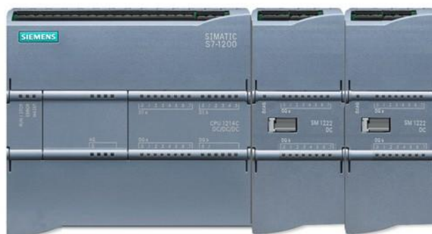
Рисунок 6-2 Реальная установка с отсутствующим модулем, сконфигурированным для слота 3, и модулем, сконфигурированным для слота 4, находящемся в слоте 3
