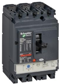
Автомат. выключатель ComPact NSX100F (36 kA при 415 В пер.тока) 3P3t, расцепитель TMD 40 A
