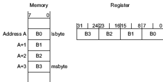
Рисунок 13. Организация расположения байтов в 32-х битной памяти
