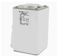
**Cartouche fusible, grande vitesse, 700 A, DC 750 V, 110 kA, size 3, 75 x 88 x 131 mm, gR, IEC, indicateur de type K**
