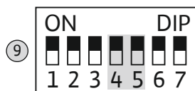
Fig. 18: Микропереключатель 2: индикация интервалов сервисного обслуживания
