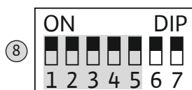
Fig. 9: Микропереключатель 1: настройка контроля подачи питания на электродвигатель
