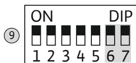
Fig. 10: Микропереключатель 2: активация насосов
