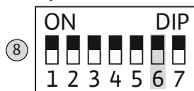
Fig. 17: Микропереключатель 1: Pump Kick
