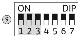
Fig. 19: DIP-переключатель 2: контроль рабочих параметров
