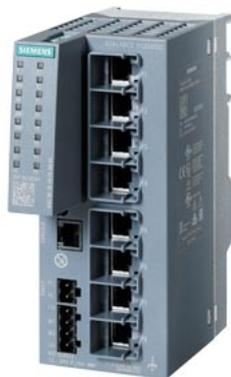
SCALANCE XC208 EEC промышленный управляемый IE коммутатор 2-го уровня; 8х электрических RJ45 портов 10/100 Мбит/с; 1х консольный порт; светодиодная индикация; резервированное питание 24В; конформное покрытие печатных плат; совместимость NAMUR NE21; расширенный температурный диапазон (от -40°C до +70°C), монтаж на DIN-рейку/S7 профили/стену; функции резервирования; офисные функции (RSTP, VLAN, ...); PROFINET IO-устройство; Ethernet/IP-совместимость; слот для C-PLUG.
