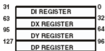
Рисунок 49 – Регистры блока управления передачей DMA
