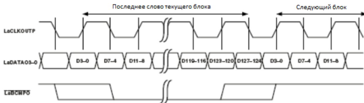
Рисунок 82 – Порт связи “а” передает порту связи “b” с завершением блока (новый блок из порта связи “а” следует немедленно после завершения первого блока)
