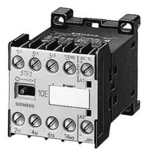
CONTACTOR, SIZE 00, 3-POLE AC-3, 4KW/400V, SCREW TERMINALS AUXILIARY CONTACT 10E (1NO) AC OPERATION AC 110V 50/60HZ
