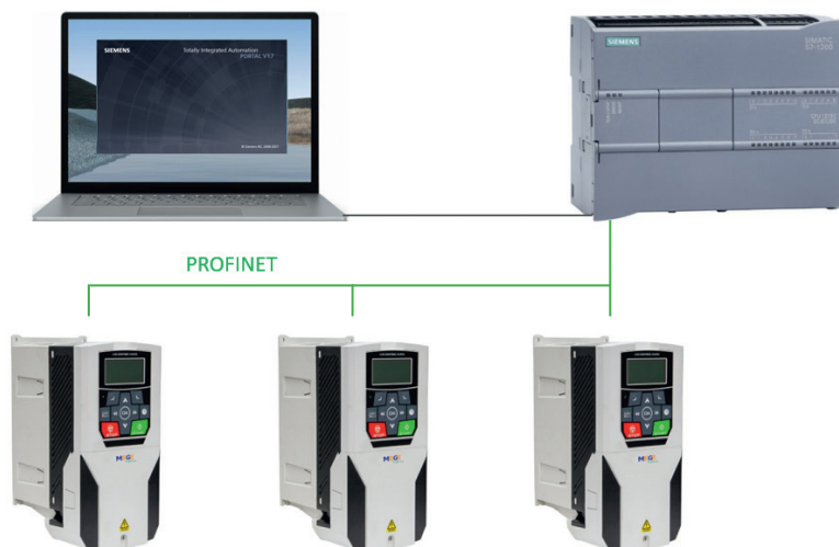
Рис. 1. Обзор устройств, подключенных к ПЛК S7-1200 в сети PROFINET
