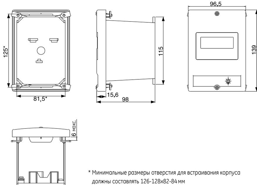
Оболочка для GPS1 – встроенный монтаж с запирающим устройством
