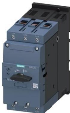
Автоматический выключатель, типоразмер S3 для защиты двигателя, класс срабатывания 10 Максимальный расцепитель тока с обратозависимой выдержкой времени 57–75 A N-расцепитель 975 A Винтовой зажим Стандартная коммутационная способность
