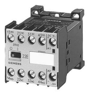
CONTACTOR RELAY 22E EN 50 011 2NO+2NC, SCREW TERMINALS AC OPERATION AC 50HZ 24V/60HZ 29V
