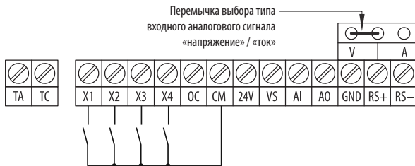
Рисунок 11 – Схема подключения сигнала типа «сухой контакт» к дискретным входам.
