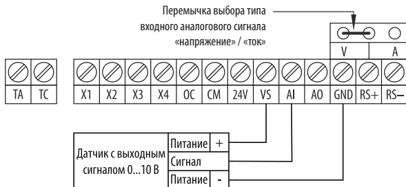
Рисунок 19 – схема подключения датчика с аналоговым выходным сигналом 0...10 В (питание от встроенного источника питания 10 В).
