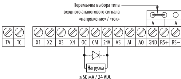
Рисунок 24 – схема подключения нагрузки к транзисторному выходу (питание от встроенного источника питания 24 В).
