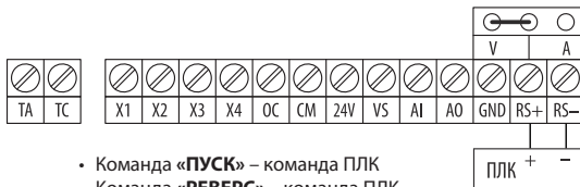
Рисунок 36 - подача команд «Пуск/Стоп» по интерфейсу RS485
