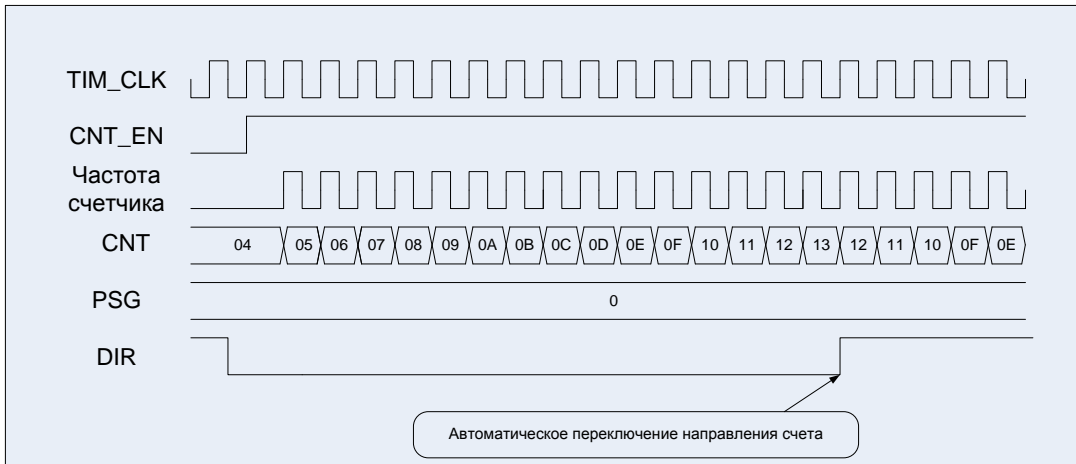
Рисунок 68 – Диаграммы работы таймера, счет вверх/вниз, сначала вверх
