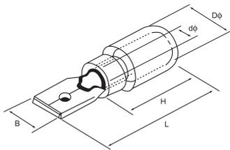
поперечное сечение провода 4~6mm<sup>2</sup> I<sub>max</sub>=24A
