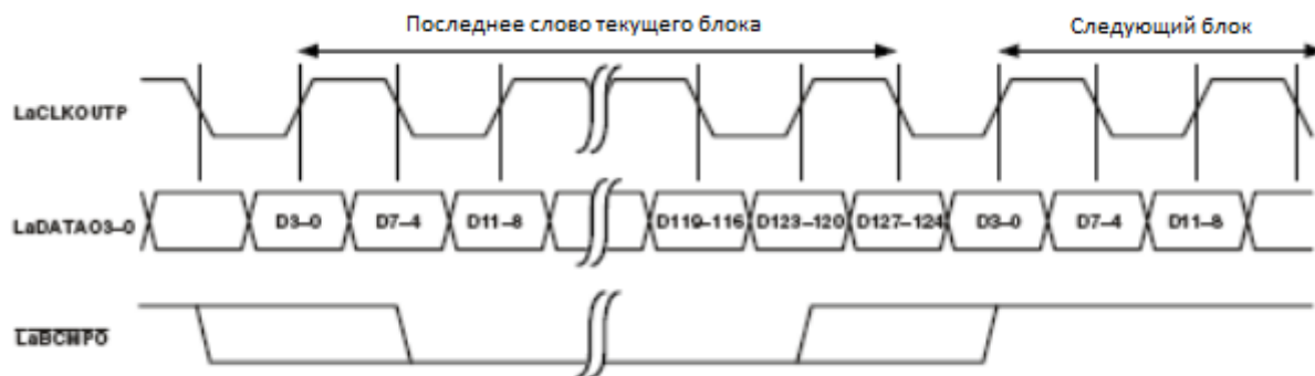
Рисунок 81 – Порт связи “а” передает порту связи “b” с завершением блока (новый блок из порта связи “а” следует немедленно после завершения первого блока)
