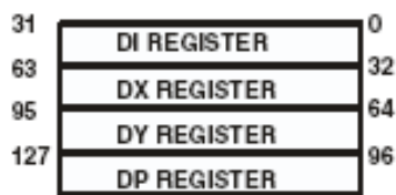
Рисунок 48 – Регистры блока управления передачей DMA
