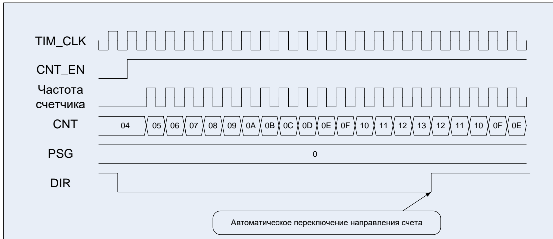
Рисунок 22 – Диаграммы работы таймера, счет вверх/вниз, сначала вверх
