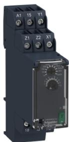
Реле времени, 8 А, 1 CO, 0.05 с...300 ч, off delay , 24...240 V AC/DC
