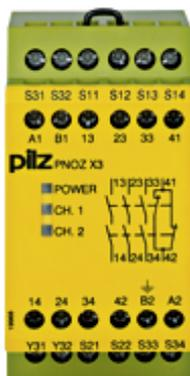
Защитное реле (автономное), входы: Одно- или двухканальные с обнаружением короткого замыкания между контактами или без него, свыходами: 3 Н/Р, 1 Н/З, 1 SC, запуск автоматически/под контролем, UB 110 В перем./24 В пост. тока, ширина: 45 мм, встроенные винтовые клеммы, мониторинг аварийного останова, защитных ограждений.
