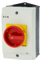
**Главные выключатели, Р1, 25 А, Монтаж на поверхность, 3-полюсн., 1 Замыкающие контакты, 1 Размыкающие контакты, Функция аварийного выключения, с красной поворотной ручкой и с желтым храповым венцом, запираемый в положении 0**
