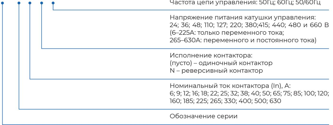
**Примечание.** Контакторы на ток 6–100 А имеют вспомогательные контакты в исполнении 1НО+1НЗ, а контакторы на ток 120–630 А – 2НО+2НЗ.
